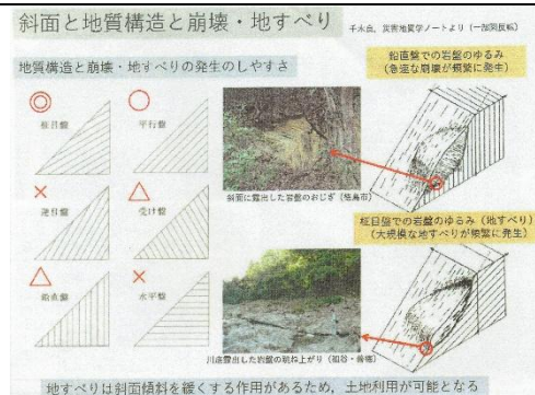
地質構造と崩壊・地すべりの関係
